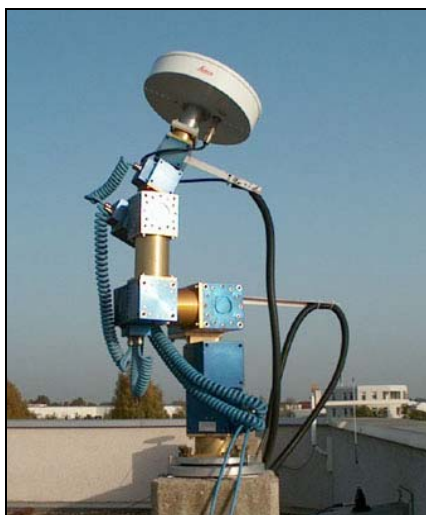
FIGURA 10: ROBÔ DE CALIBRAÇÃO DE ANTENAS GPS – IfE (HANNOVER)
